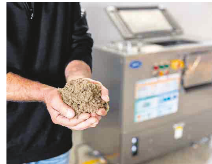
Nach der Faseraufbereitung im Bio-Konverter bleibt ein sehr zellulosehaltiger Sekundärrohstoff, der zu Industripappe weiterverarbeitet werden kann. Foto: PAPERSTAR
